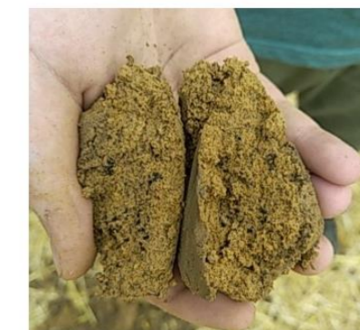
Concrétions noirâtres à 50cm de profondeur
