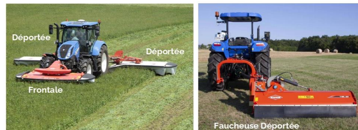
Exemples de faucheuse déportée et frontale
