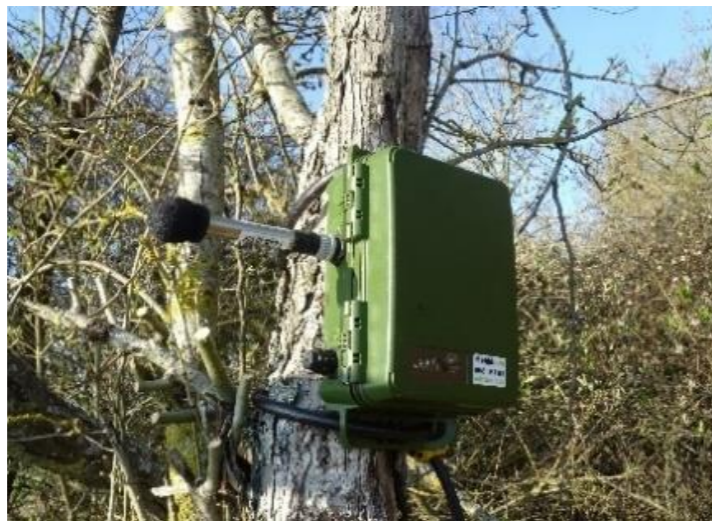
Photo 2 : Détecteur d'ultrasons utilisé lors de l'étude
